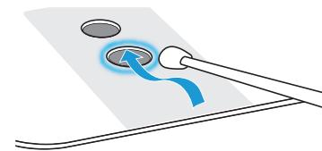
Empuje firmemente la punta del hisopo desde el orificio inferior hasta que se vea en el orificio superior.
