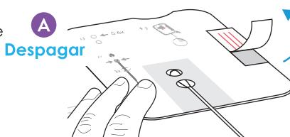
Cierre el lado izquierdo de la tarjeta sobre el hisopo. Presione firmemente sobre las dos líneas del borde derecho de la tarjeta para sellarla.
